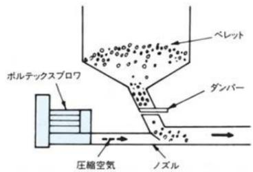
塩化ビニール、ポリエチレンなどのペレット状原料の空気輸送に使用されます。(吸引式も可能)
