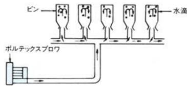
洗ビン後のビン内部に残った水滴を取り除くのに利用されています。
