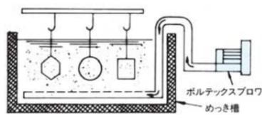
めっきの品質化のために槽内に空気を送って電解物を循環させます。
