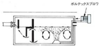
沈殿物をかきまわしたり、あるいは比較的浅い水処理プラントの浄化用に使用されています。
