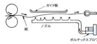
ノズルから吹き出す空気で紙をガイド板の下側に保持し、紙の下面が機器に触れてよごれるのを防ぎます。
