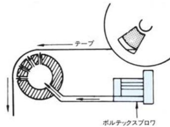
ボルトテックスブロウによる空気軸受はテープの摩擦がなく、長寿命を保ちます。
