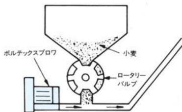
ロータリーバルブで区分けされて落下する小麦などの空気輸送に使用されています。
