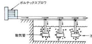
比較的浅い池で、水中酸素補給用として使用されています。
