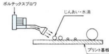
プリント基板のじんあい・水滴除去にボルトテックスブロウが使用されます。ボルトテックスブロウでエアを吹きつけプリント基板上の微粒子(じんあい・水滴)を除去します。
